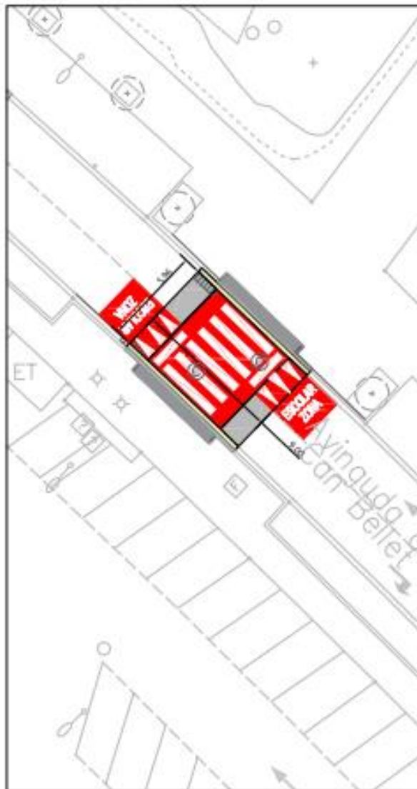
ÀMBIT 2 - PAS DE VIANANTS ELEVAT
